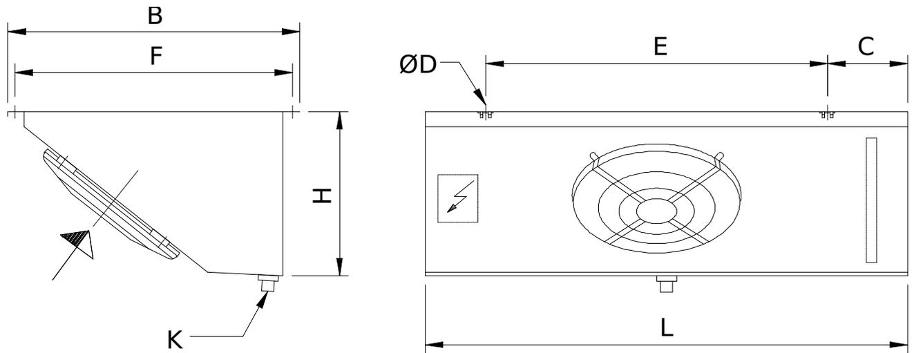
Ablauf nach DIN ISO 228-1 mit G-Gewinde (Flachdichtung).
